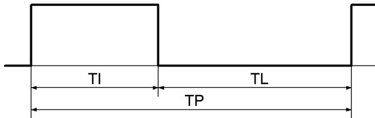
Erzeugung eines PWM-Signales mittels der PWM-Einheit an P7.0
